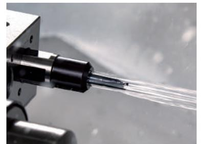
TBMFR07 与 4 个冷却孔工具套筒相结合，可提供卓越的加工稳定性
