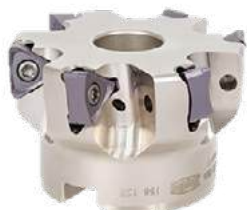
刀盘式 TPTN12 (ø50 - ø125mm) 芯轴式用于方肩铣削
