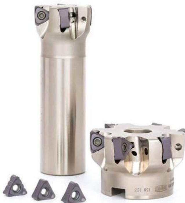
刀杆式 EPTN07/12 (ø18 - ø40 mm) 圆柱柄型用于方肩铣削
