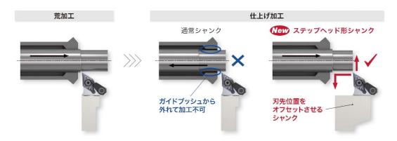
突切り加工用ヘッド、倣い加工用ヘッド、ステップヘッド形シャンクはすべて内部給油に対応しているため、摩耗を抑制し、切りくずトラブルを最小限に抑えることができます。
