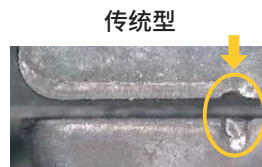
因刃口强度不足导致刃口断裂
