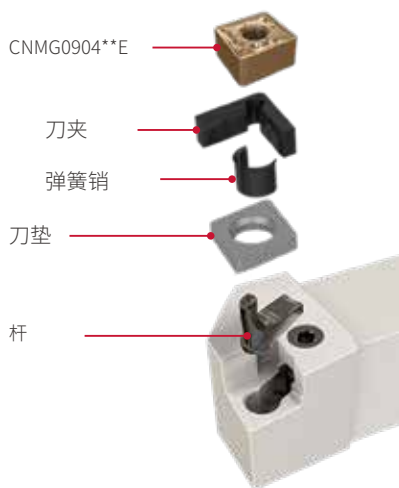
用于 CNMG12 的刀夹 → Eco CNMG09
