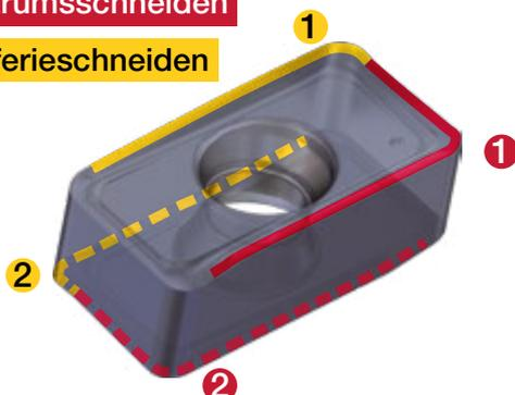
Eine einzelne Wendeschneidplatte kann entweder als Zentrumsschneide oder als Perifereschneide verwendet werden und kann in jeder Position zweimal eingesetzt werden – **vier Schneidkanten für höchste Wirtschaftlichkeit der WSP.**
