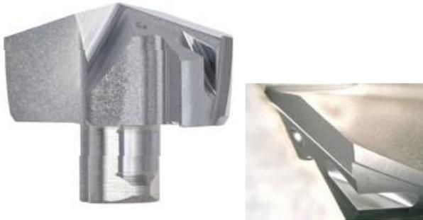
锋利的无涂层切削刃口设计，在非铁金属钻孔中，可有效防止积屑瘤，并实现良好的排屑。
